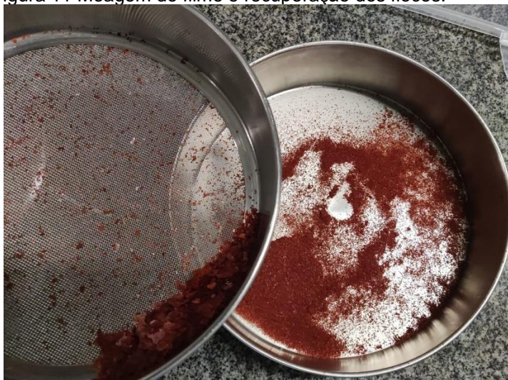
Figura 11 Moagem do filme e recuperação dos flocos.
