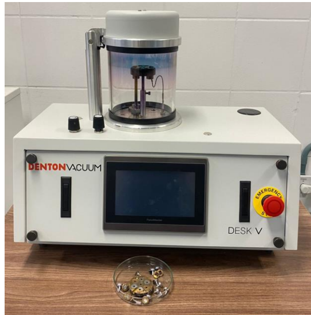
Figura 26: Equipamento de revestimento de superfície em ouro do LEBm.
