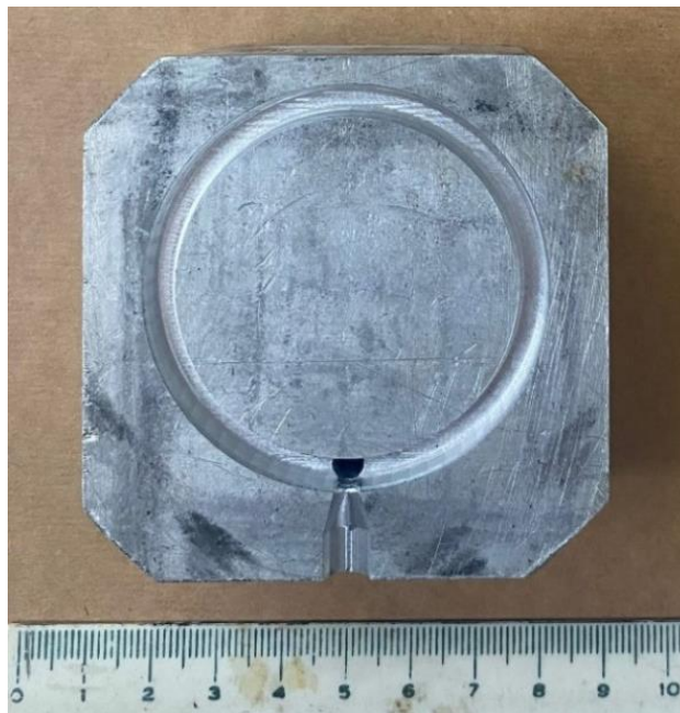
Figura 24: Molde de injeção, em alumínio, do anel intravaginal.
