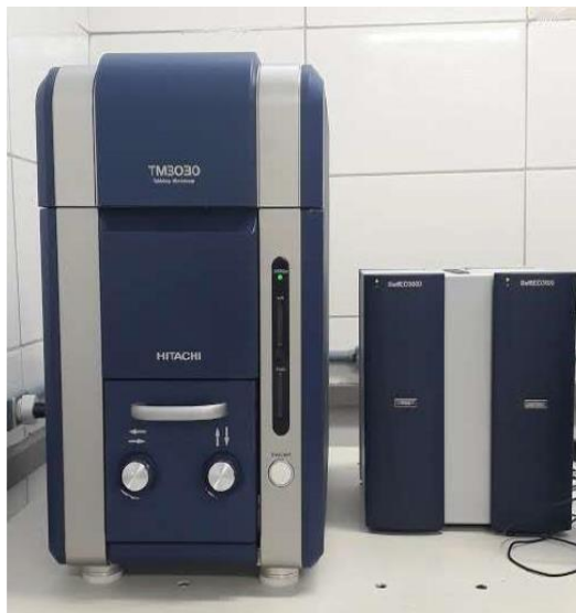
Figura 28: Microscópio eletrônico de varredura localizado no CERMAT-UFSC.
