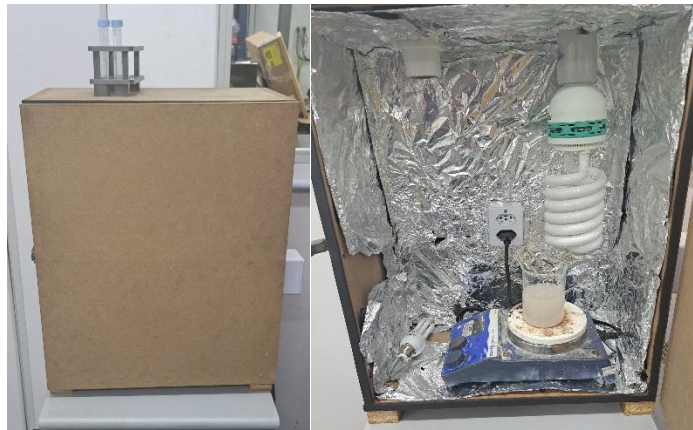
Figura 9: Reator utilizado para realização de ensaios de fotocatalise, exterior (esquerda) e interior (direita).
