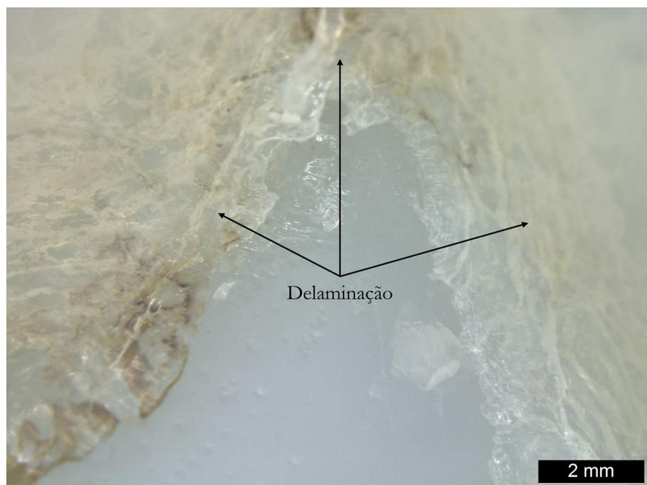
Figura 5 – Imagem Representativa de Dano por Delaminação. Banco de dados do Autor.
