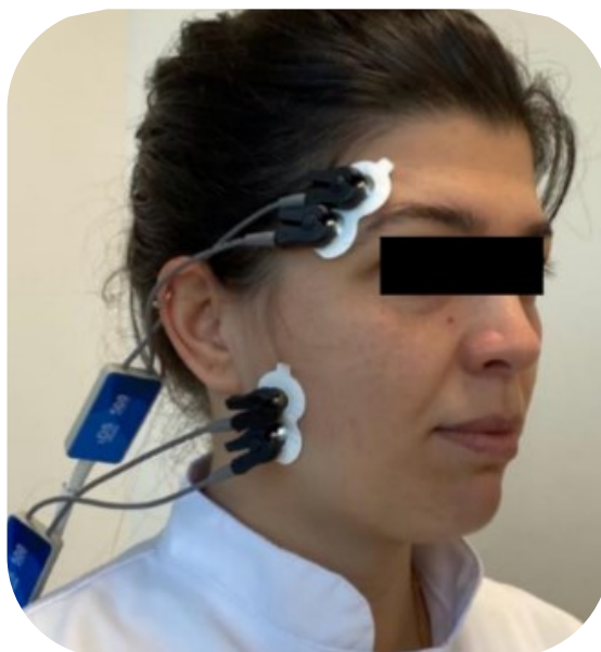
Figura 2 - Disposição dos eletrodos sobre os músculos masseter e temporal.
