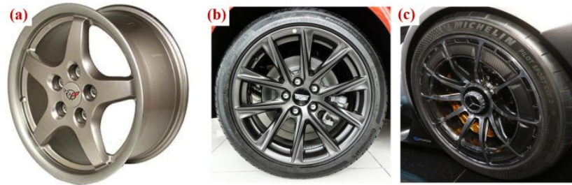
Figura 4 – Aplicação de ligas de magnésio em rodas: (a) Chevrolet Corvette ; (b) Cadillac CT4-V ; (c) AMG One
