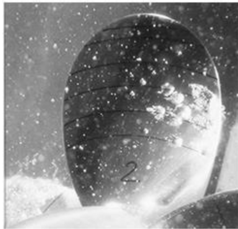
Figura 7 – Cavitação em uma pá de um propulsor
