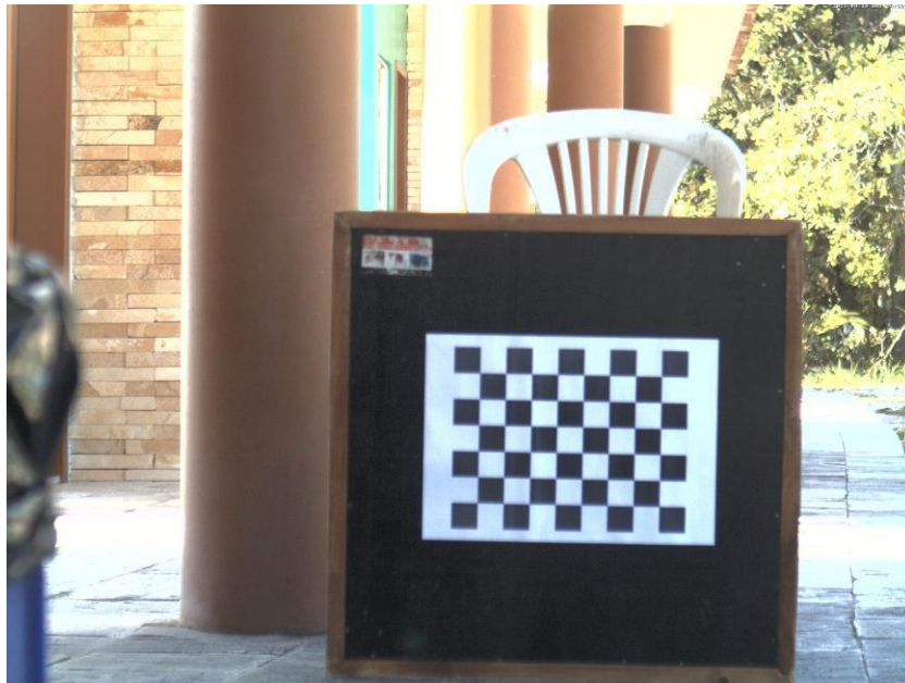
Figura 5 - Exemplo de imagem utilizada para calibração da câmera.
