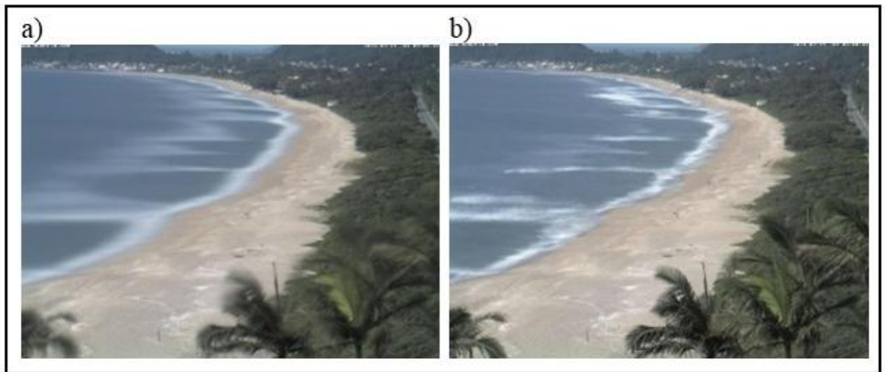
Figura 4 -Exemplos dos tratamentos de imagens realizados a) timex e b) imagem de média móvel
