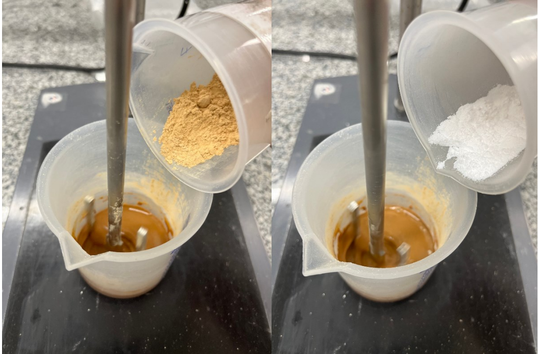
Figura 4 – Adição dos precursores bentonita calcinada e alumina à solução alcalina
