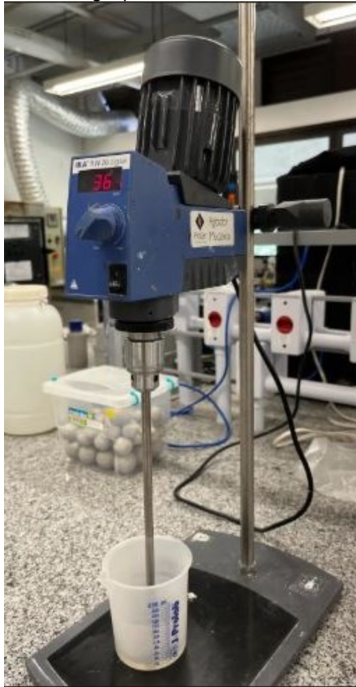
Figura 2 – Agitador mecânico utilizado na preparação da solução alcalina e na síntese de geopolímero
