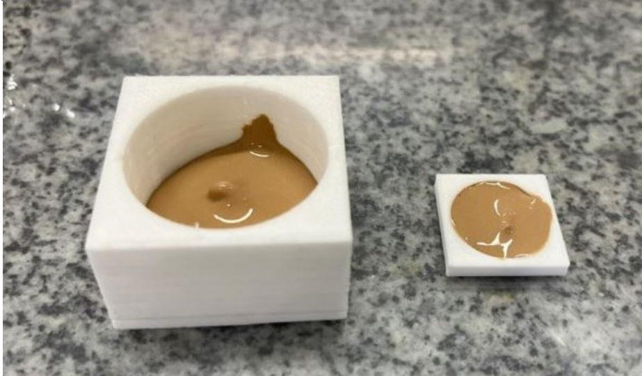
Figura 6 – Mistura resultante da síntese de geopolímero em moldes para etapa de cura.
