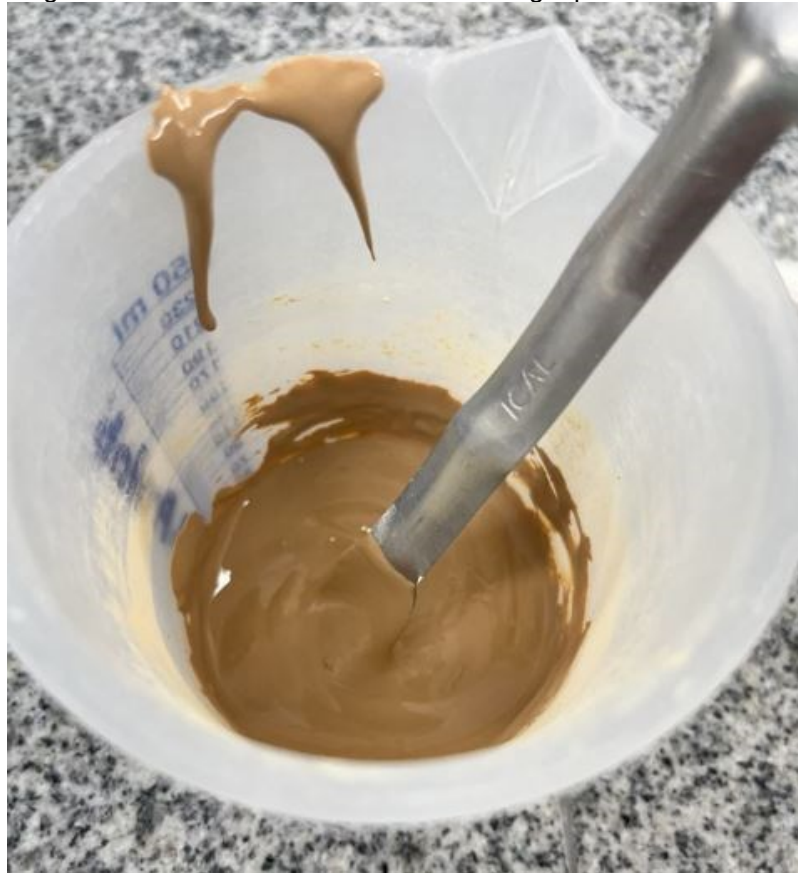
Figura 5 - Mistura resultante da síntese de geopolímero
