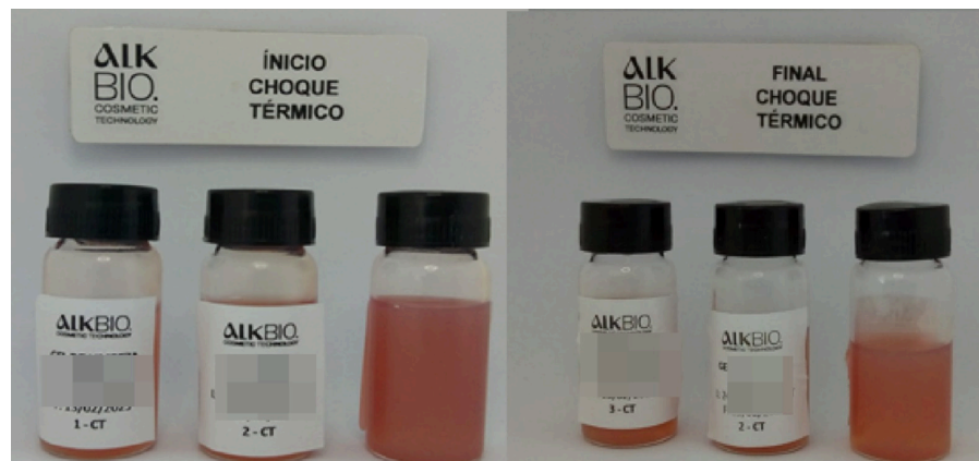
Figura 17: Amostra gel de limpeza no início e final do choque térmico.
