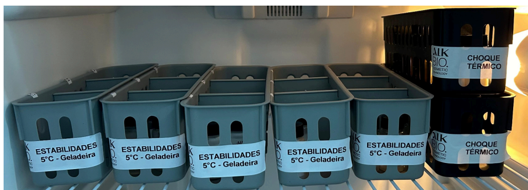
Figura 8: Geladeira para armazenamento das amostras de estudo de estabilidade acelerada, com temperatura de 5^{\circ}\text{C} \pm 2^{\circ}\text{C} .
