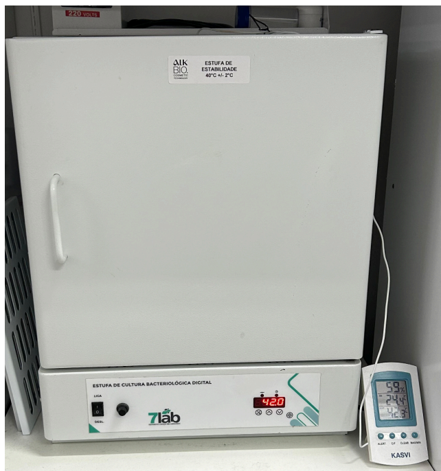
Figura 7: Estufa para estudo de estabilidade acelerada, com temperatura de 40^{\circ}\text{C} \pm 2^{\circ}\text{C} .
