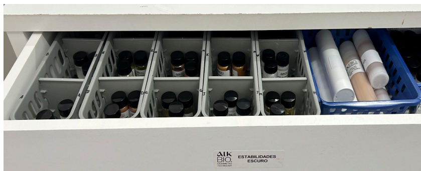
Figura 9: Local para armazenamento das amostras de estudo de estabilidade acelerada, com ambiente de 25^{\circ}\text{C} \pm 2^{\circ}\text{C} sem exposição a radiação luminosa direta.
