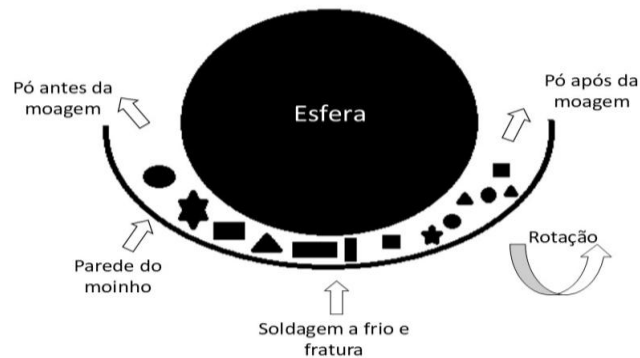
Figura 7 - Esquema colisões entre esfera e partícula do material moído
