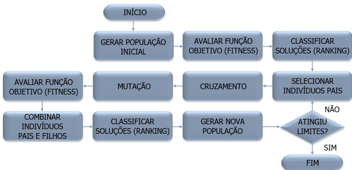
Figura 17 – Fluxograma do ciclo típico de uma iteração do NSGA-II.
