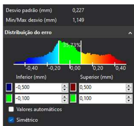
Figura 90 – Distribuição de erro entre o plano gerado e a superfície de corte
