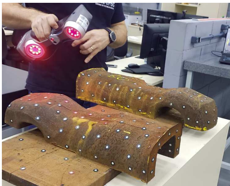
Figura 46 – Escaneamento de partes da haste rotativa do engate
