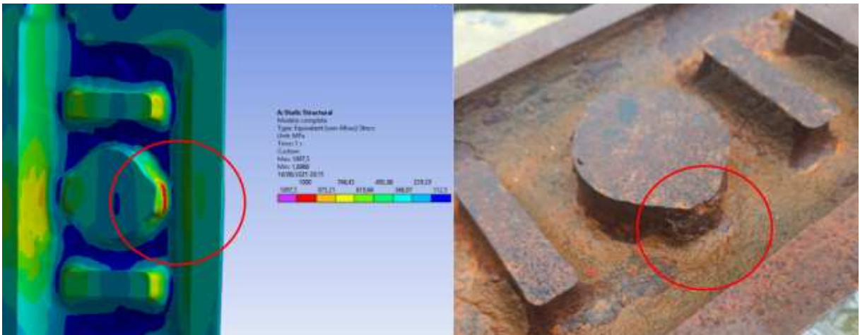
Figura 81 – Concentração de tensões por defeito de fundição na mandíbula
