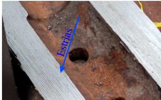
Figura 50 – Estrias resultantes do atrito com a lateral da lâmina
