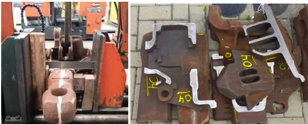
Figura 44 – Engate Rotativa submetido ao processo de corte
