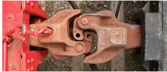
Figura 8 – Acoplamento realizado com dois engates tipo E 4
