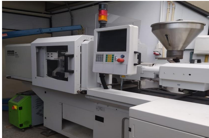
Figura 22 – Máquina de moldagem por injeção Arburg.
