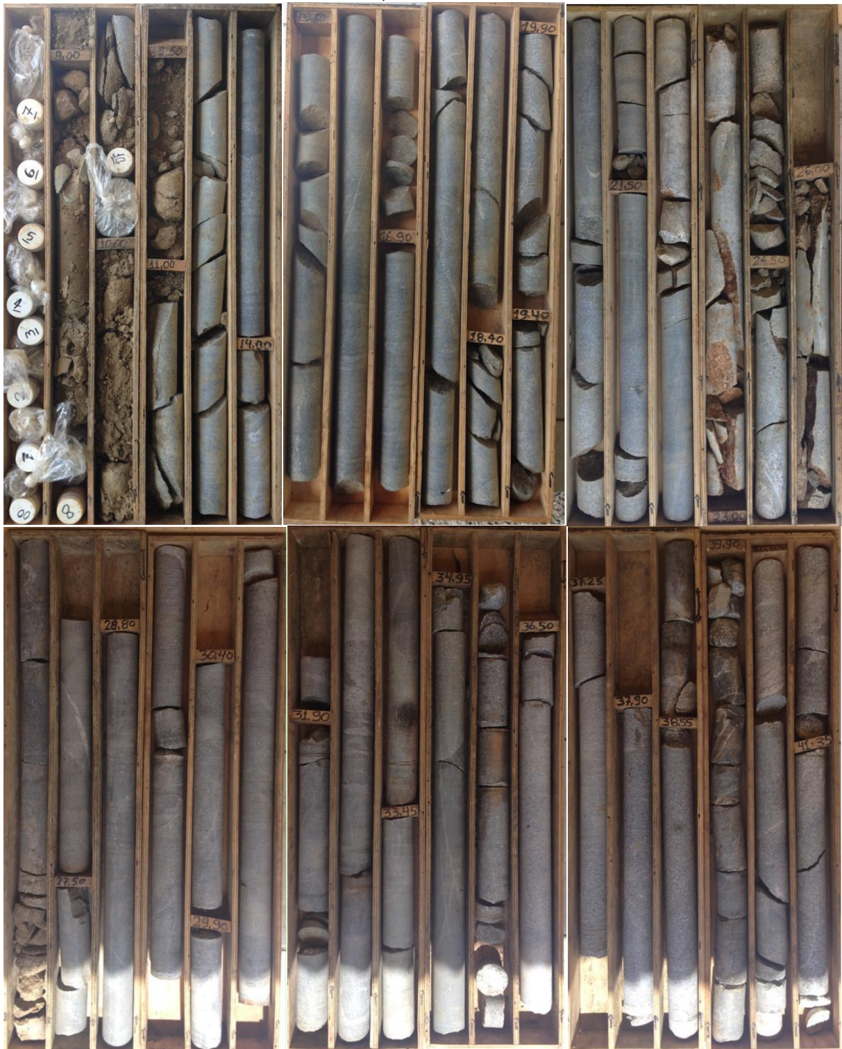
Figura 27 – Testemunho de sondagem SM-3011, executada até a profundidade de 50,20 metros.
