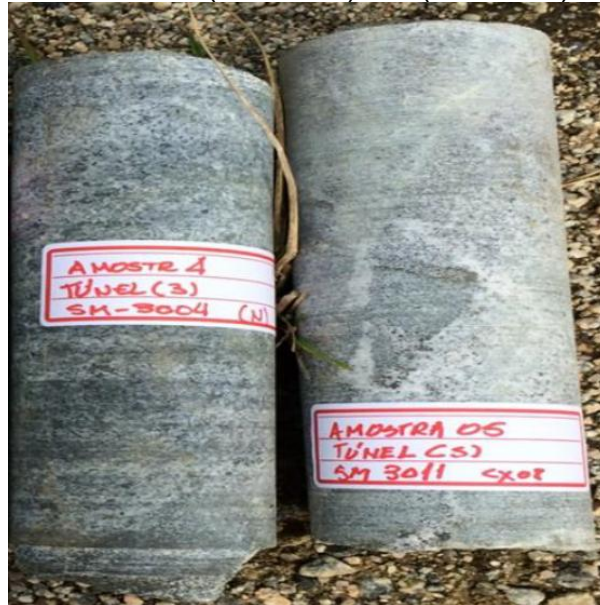
Figura 28 – Testemunhos de sondagens selecionados para a confecção das amostras 4 (SM-3004) e 5 (SM-3011).
