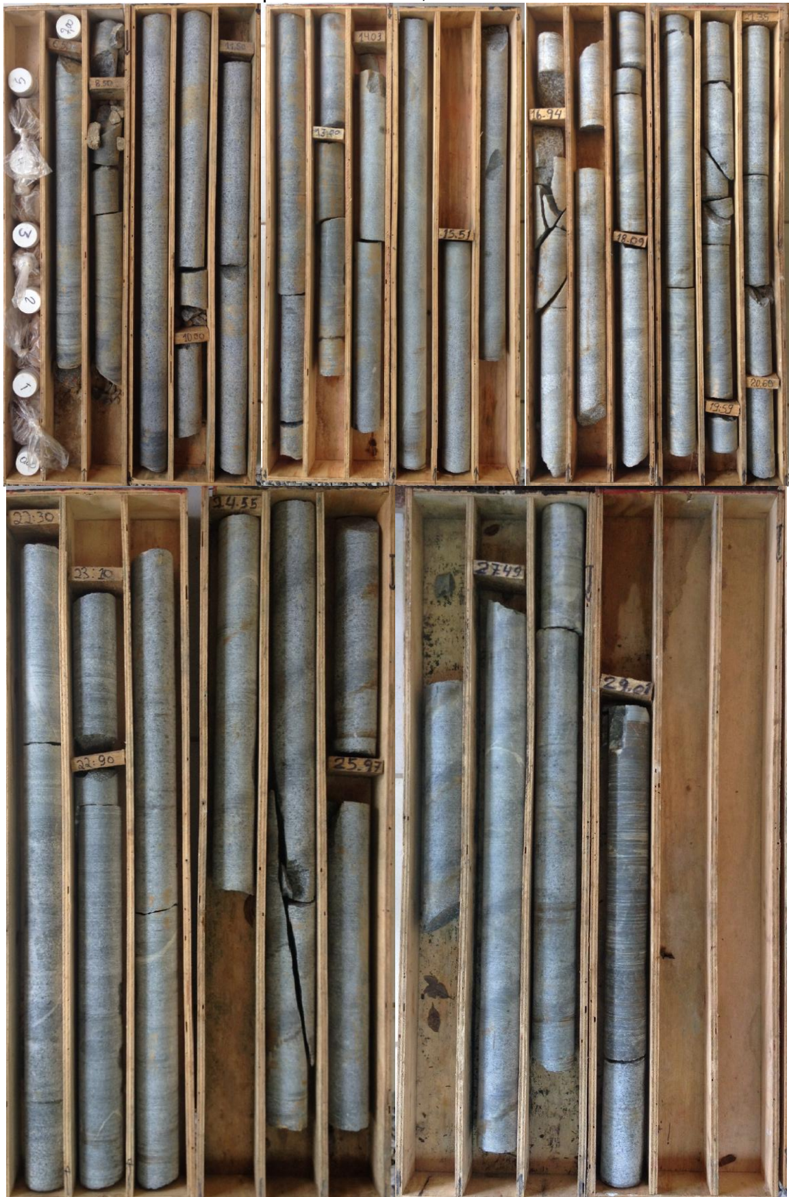
Figura 26 – Testemunho de sondagem mista SM-3004, executada até a profundidade 29,01 metros.
