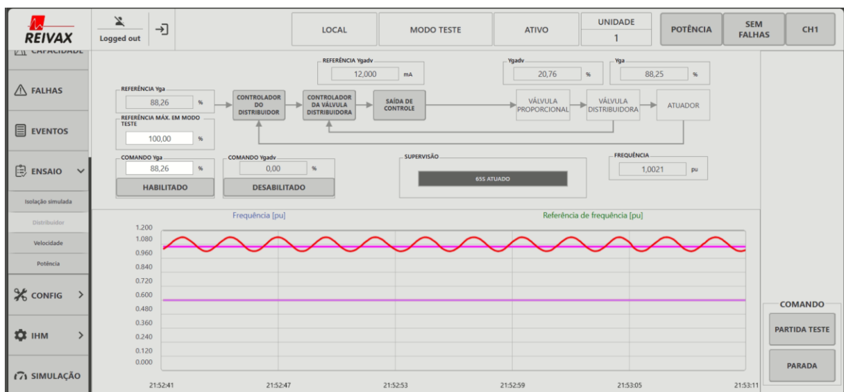
Figura 8 – Tela de parametrização de variáveis de controle da válvula distribuidora e do atuador (distribuidor) da turbina.
