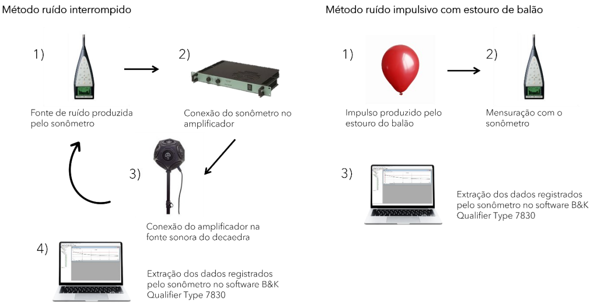
Figura 14. Esquema dos métodos de medição in loco
