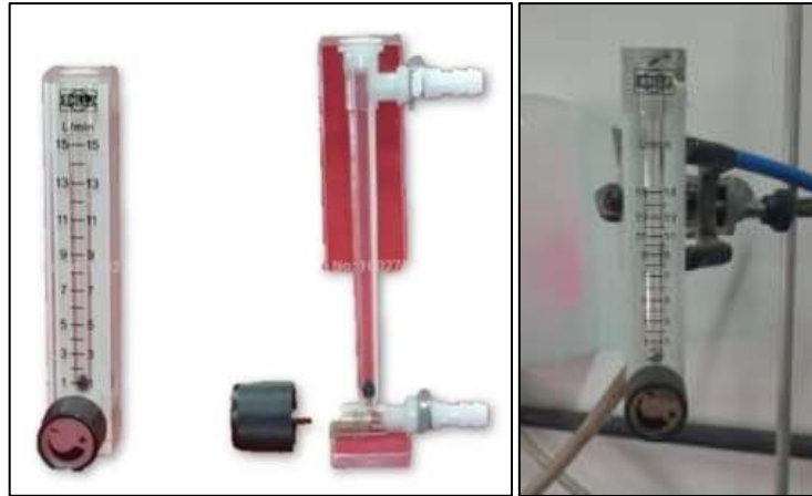
Figura 16 - Rotâmetro de acrílico para vazão de 1 a 15 L/min.
