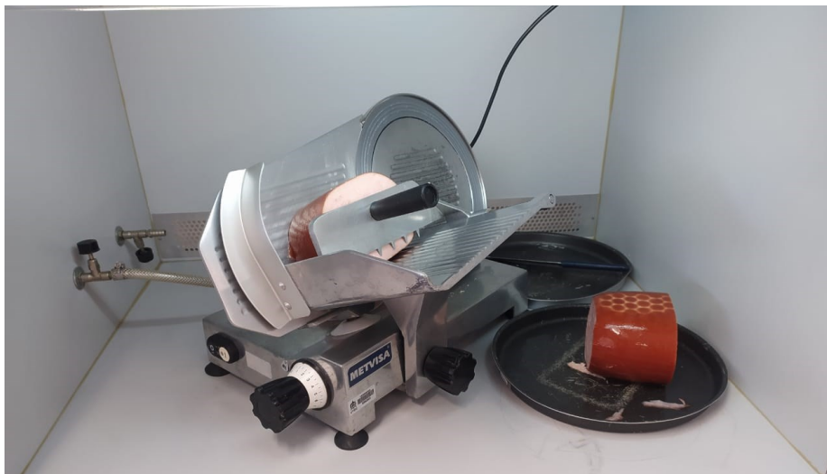
Figura 5.3 Fatiador e utensílios utilizados no fatiamento de presunto de peru defumado.
