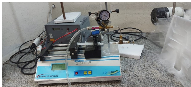
Figura 13 – Esquema de fiação a sopro de solução (FSS).
