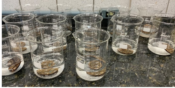
Figura 34 – Ensaio de absorção de água
