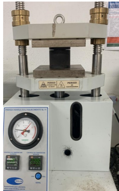
Figura 14 – Imagem da prensa com molde durante o aquecimento do material
