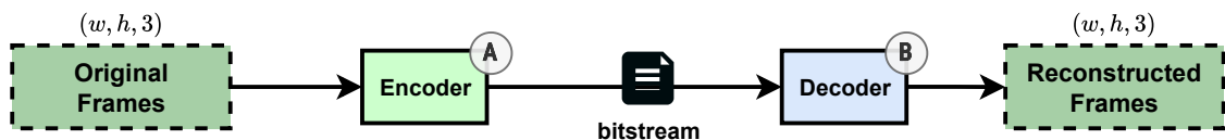
Figura 1 – Modelo de compressão em uma única camada. O codificador mantém a resolução da entrada em sua saída.
