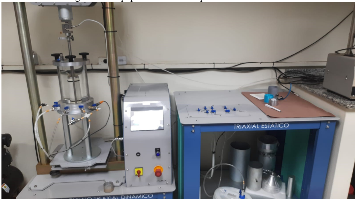
Figura 46 – Equipamento utilizado para os ensaios triaxiais
