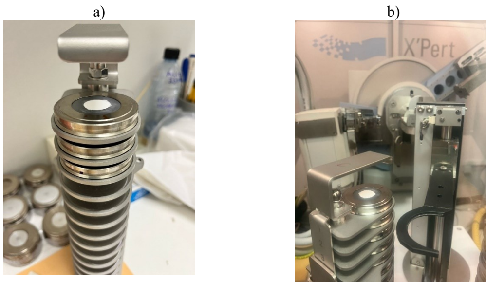
Figura 36 – Amostras prontas para o ensaio. a) alocadas na torre de porta-amostras e b) torre alocada no difratômetro de raios X.
