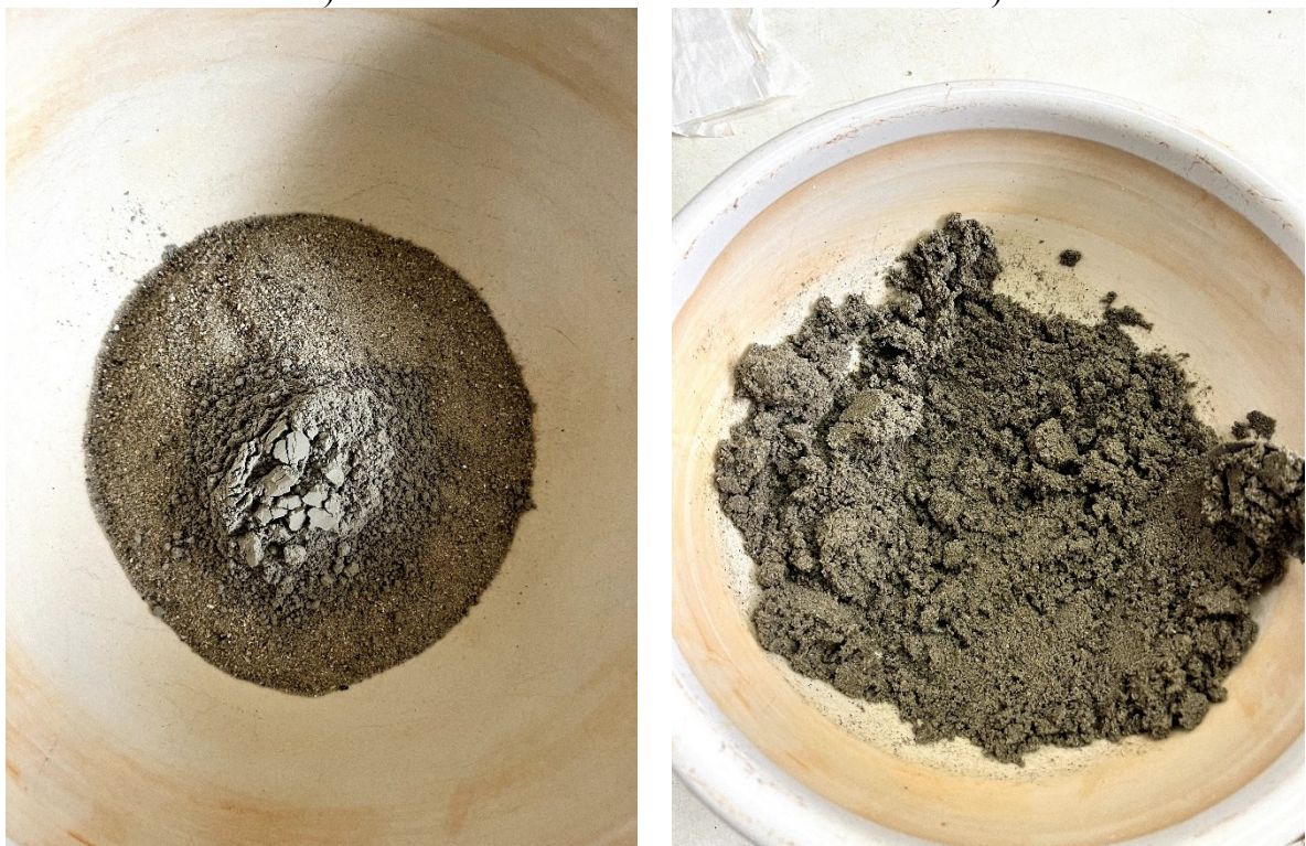
Figura 41 – a) mistura do cimento + aditivo com a areia e b) mistura final com água
