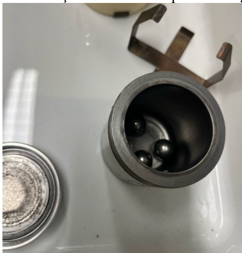
Figura 32 – Pote de aço inox utilizado para a moagem do \text{SiO}_2
