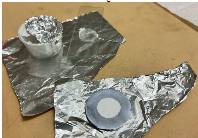
Figura 35 – Preparação das amostras para ensaio DRX usando porta-amostras de Si “zerobackground”.
