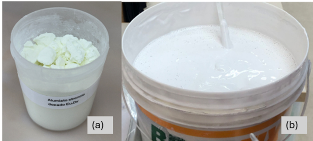
Figura 11 – a) Composto fosforescente - Aluminato de estrôncio dopado EuDy, b) manta impermeabilizante
