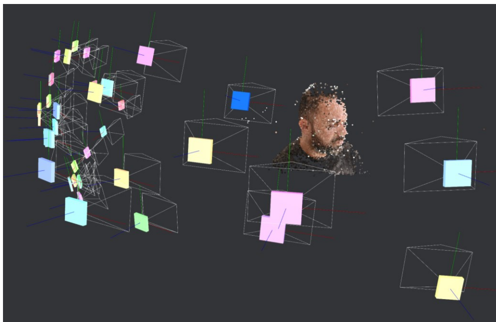
Figura 3 – Processo de reconstrução com fotogrametria
