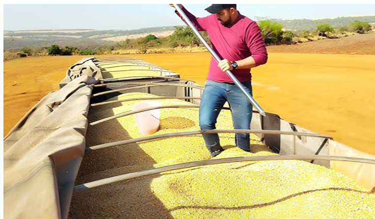
Figura 12 – Foto de um operador coletando amostras com um calador composto.
