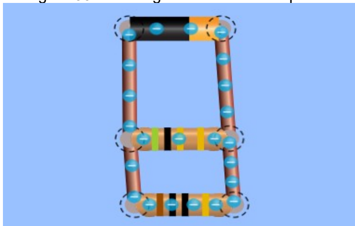
Figura 33 – Montagem de circuito em paralelo
