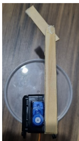
Figura 54a – Fixação do dedo fixo ao suporte do servo motor
