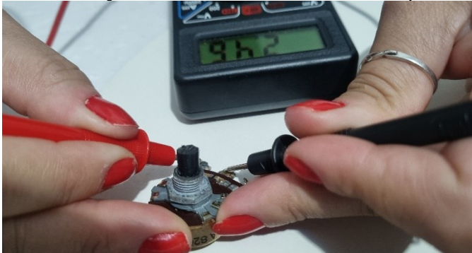
Figura 39 – Medição da resistência variável do potenciômetro
