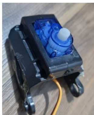
Figura 50a – Fixação do servo motor no suporte Pan Tilt
