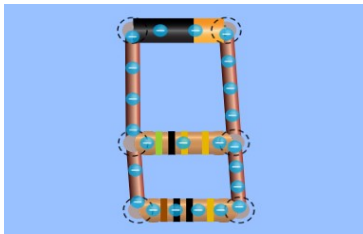
Figura 32 – Montagem de circuito em paralelo
