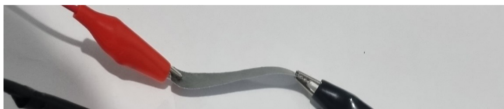
Figura 20 – Posição correta para medição da resistência
