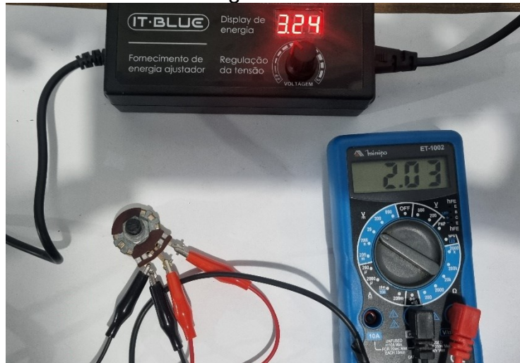
Figura 18 - Potenciômetro ligado a fonte como divisor de tensão
