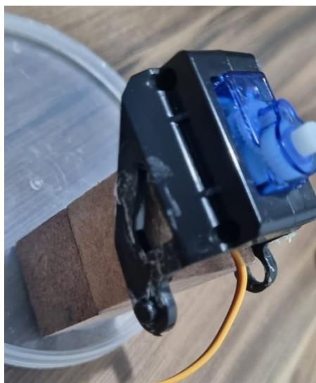
Figura 51 – Fixação do suporte com servo motor na estrutura da base
