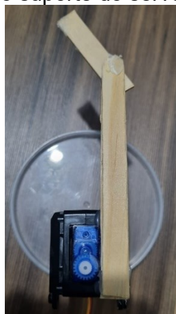
Figura 55 a – Fixação do dedo fixo ao suporte do servo motor
