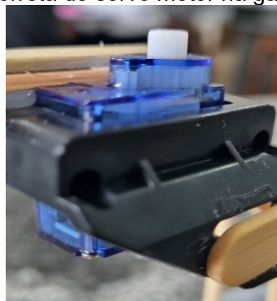
Figura 25 - Fixação correta do servo motor na garra robótica com palitos
