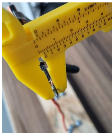
Figura 16 – Medição correta do diâmetro com paquímetro
