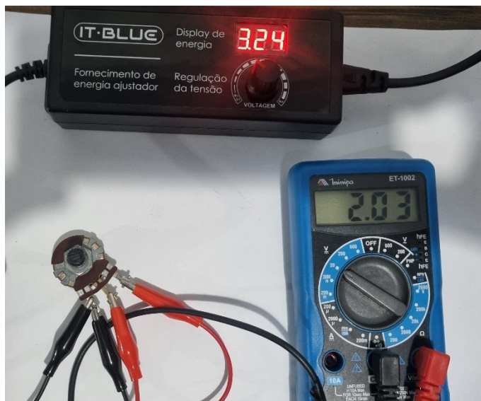
Figura 39 – Potenciômetro como divisor de tensão
