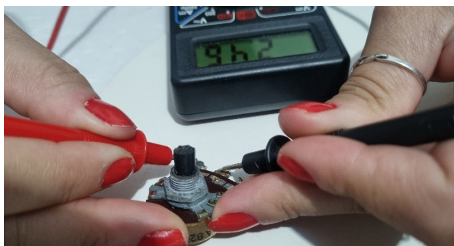
Figura 38 – Medição da resistência variável do potenciômetro
