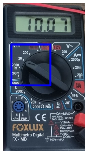
Figura 2b – multímetro na posição de medir tensão em volts.
