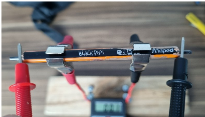
Figura 17 – Medição correta como multímetro em escala de Ohms
