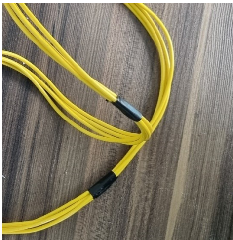
Figura 47 – Organização da extensão de fios com fita isolante
