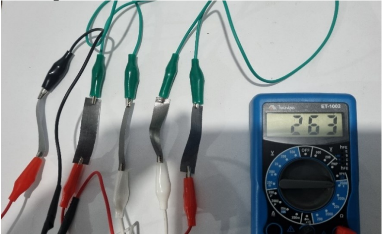
Figura 12 - Conexão dos resistores em série
