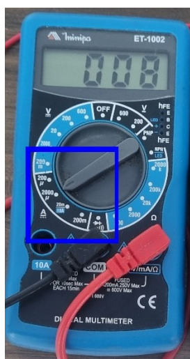
Figura 2a – multímetro configurado para medição de corrente em \mu A
