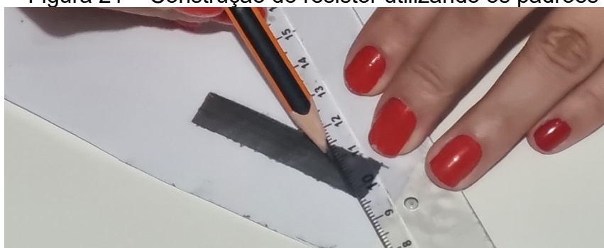
Figura 21 – Construção do resistor utilizando os padrões
