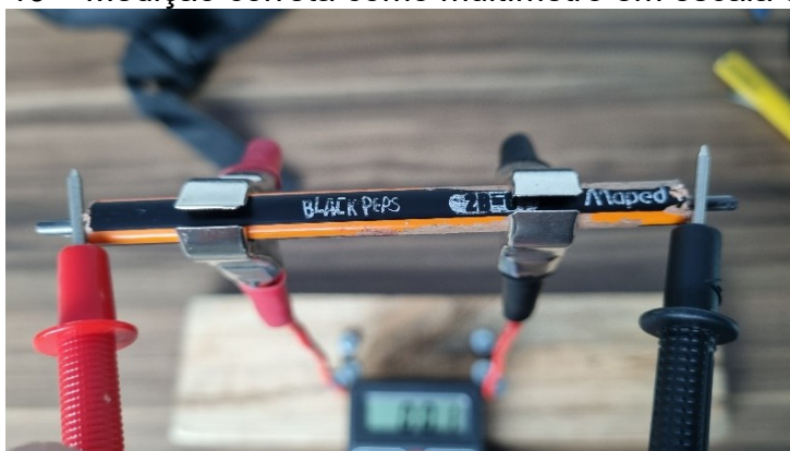
Figura 19 – Medição correta como multímetro em escala de Ohms
