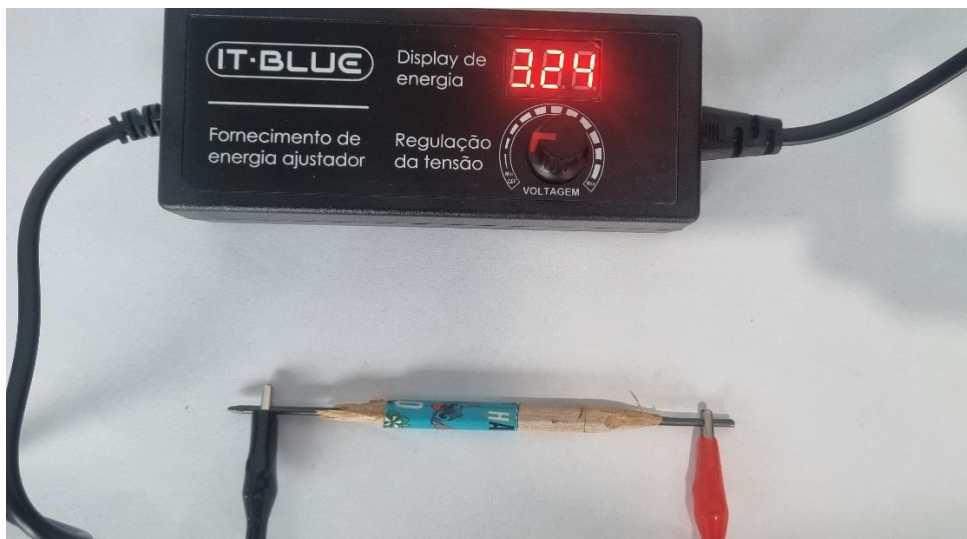
Figura 7 - Montagem do experimento para observação do efeito joule
