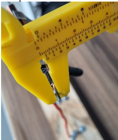
Figura 18 – Medição correta do diâmetro com paquímetro
