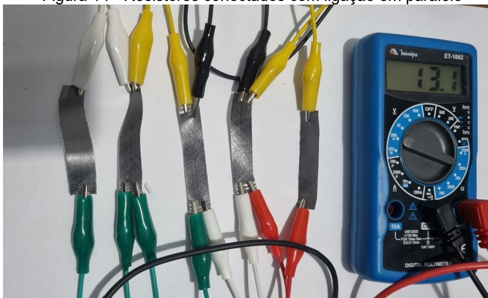
Figura 14 - Resistores conectados com ligação em paralelo
