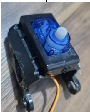
Figura 51 a – Fixação do servo motor no suporte Pan Tilt
