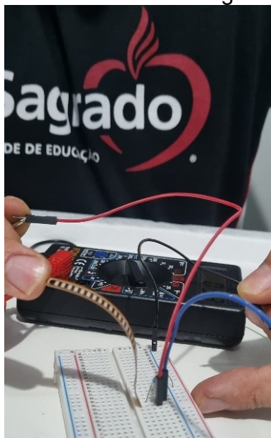
Figura 20 - Aluno medindo resistor flexível ligado como divisor de tensão
