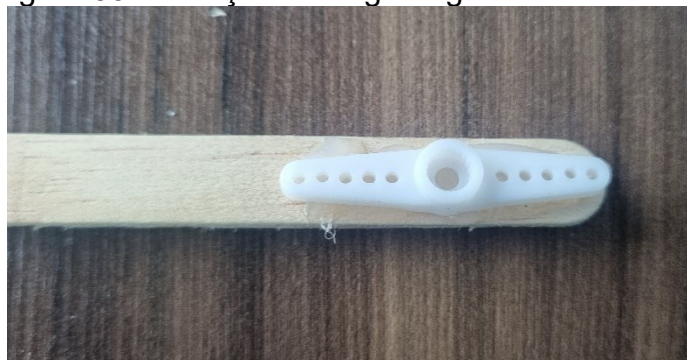
Figura 58 – Fixação da engrenagem no dedo móvel
