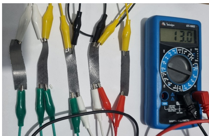
Figura 24 – Medição da associação dos resistores em paralelo
