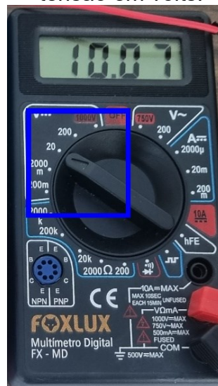
Figura 4b – multímetro na posição de medir tensão em volts.
