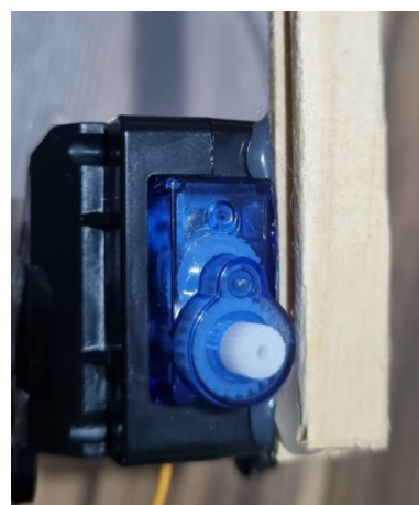
Figura 54b – Detalhe da fixação do dedo fixo
