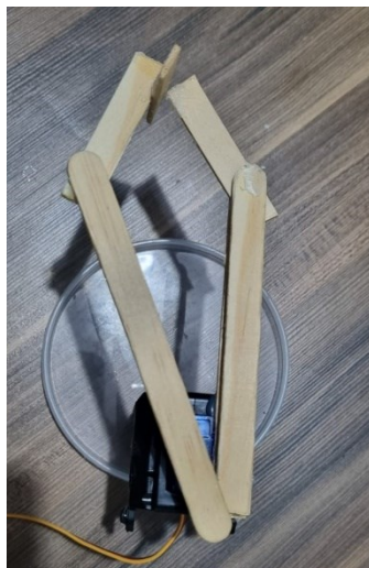
Figura 59 – Encaixe do dedo móvel no servo motor
