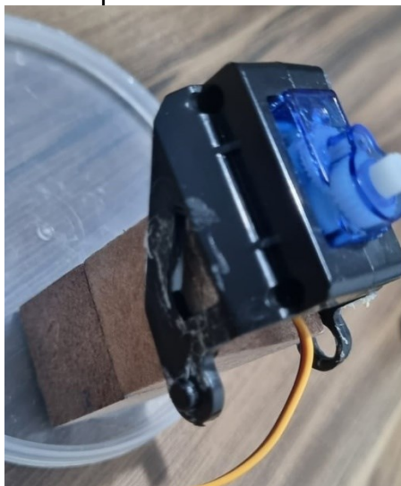
Figura 52 – Fixação do suporte com servo motor na estrutura da base
