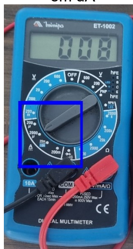
Figura 4a – multímetro configurado para medição de corrente em \mu\text{A}
