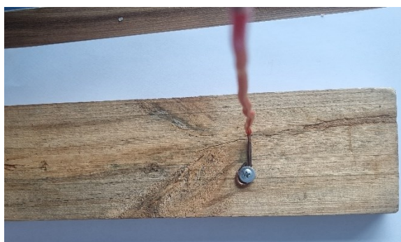
Figura 12 – Fixação das hastes na base
