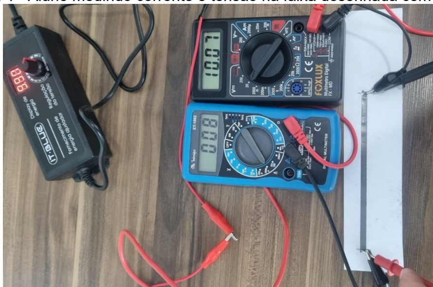
Figura 4 - Aluno medindo corrente e tensão na faixa desenhada com lápis 8B
