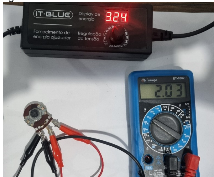
Figura 40 – Potenciômetro como divisor de tensão
