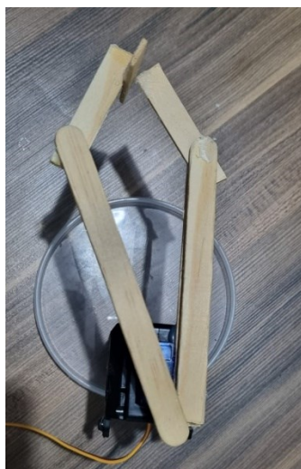
Figura 58 – Encaixe do dedo móvel no servo motor
