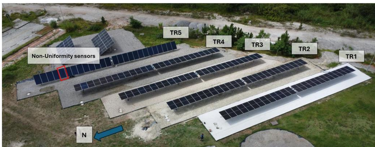
Figura 6-1 - Usina fotovoltaica piloto de pesquisa composta por seis sistemas FV distintos, com diferentes condições de albedo, localizada no Laboratório de Energia Solar Fotovoltaica/UFSC, em Florianópolis, Brasil. Os sistemas analisados incluem TR1 (brita branca), TR2 (caulim), TR3 (areia) e TR4 e TR5 (bica corrida).
