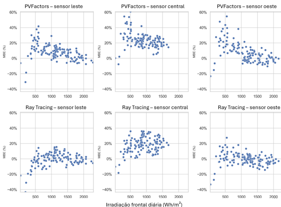
Figura 6-8 - Erro médio diário ( Mean Bias Error – MBE) entre a irradiância traseira simulada e medida em função da irradiância frontal diária, para os métodos PVFactors e RT, nas posições dos sensores leste, centro e oeste. O viés é mais pronunciado em níveis baixos de irradiância, com o PVFactors ultrapassando +40% abaixo de 500 Wh/m².
