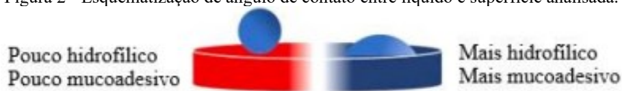
Figura 2 - Esquematização de ângulo de contato entre líquido e superfície analisada.
