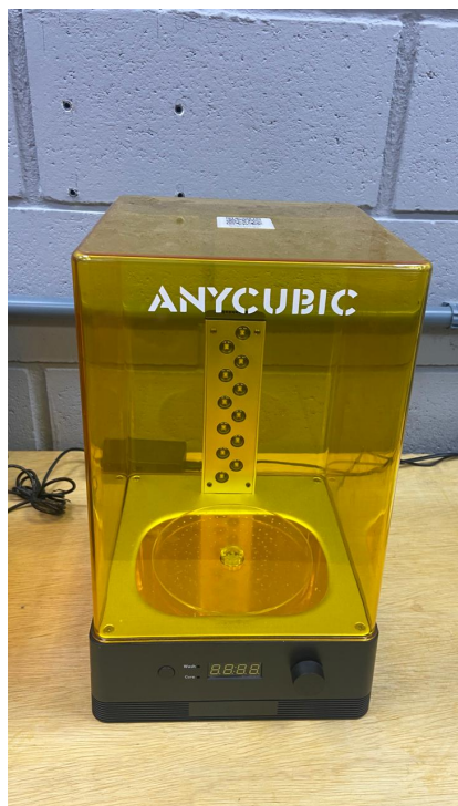
(a) Estação Anycubic Wash e Cure 2.0.
