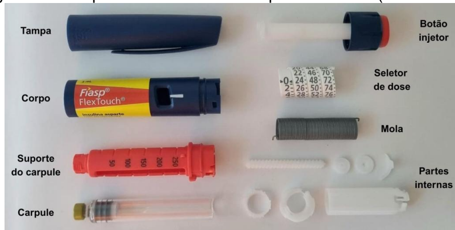
Figura 2 – Componentes da caneta Fiasp® FlexTouch® (Novo Nordisk)
