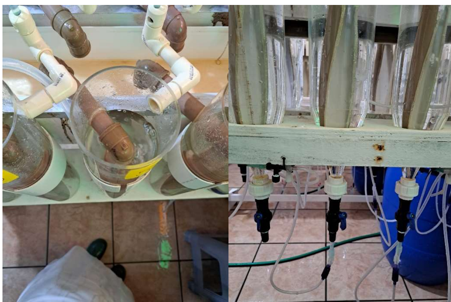
Figura 9 - Uso da aeração inserida na parte inferior. A esquerda vista superior e à direita detalhe do filtro utilizado do sistema de aeração.
