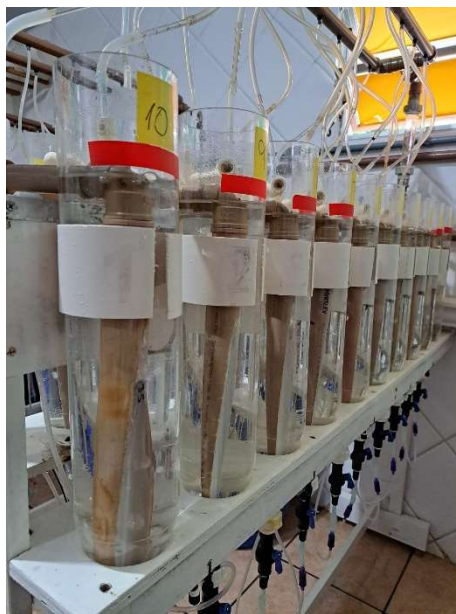
Figura 7 - Garrafas e penas do Sistema de Recirculação de Água.
