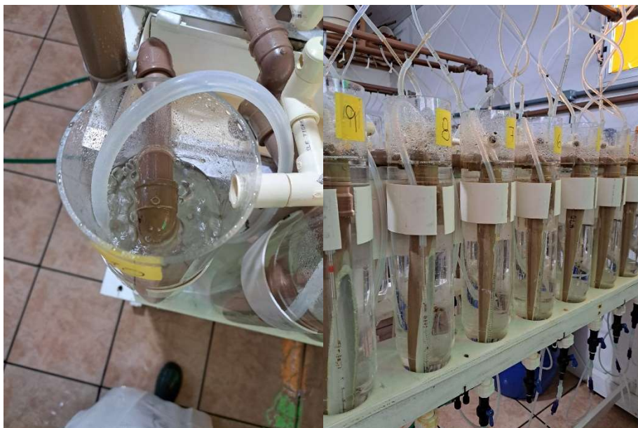
Figura 8 – Uso da aeração inserida pela parte superior. A esquerda vista superior e à direita vista frontal do RAS.
