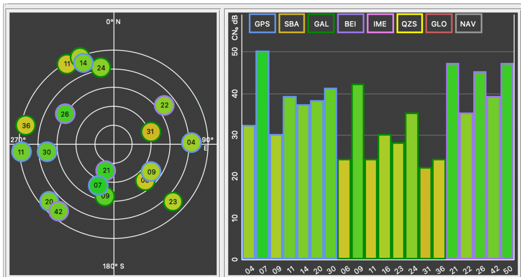
Figura 5.1: Posição dos satélites e os seus C/N_0 com antena projetada e plano de terra.
