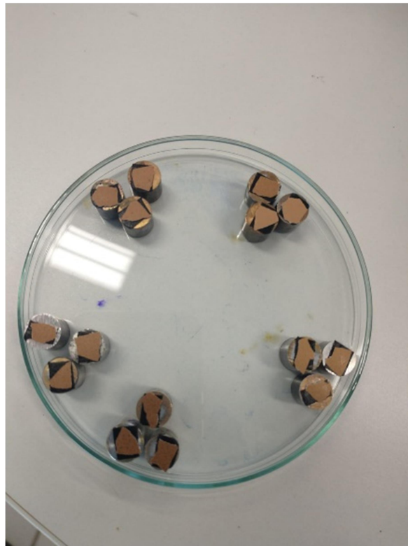
Figura 4 – Colocação das cascas nos stubs.
