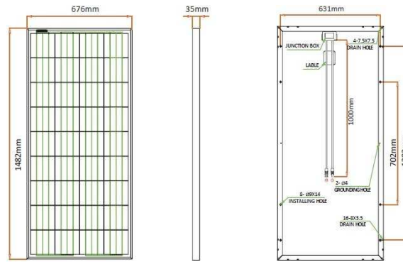
Figura 9 – Painel solar fotovoltaico (SOLAR, 2023)
