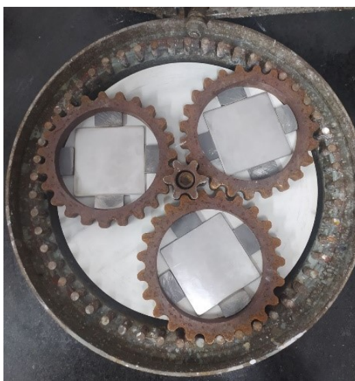
Figura 30 - Disposição das peças de trabalho na lapidadora
