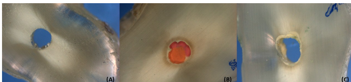
Figura 3. Imagens obtidas em estereomicroscópio com aumento de 35x após o teste de push-out: em A falha adesiva, em B falha coesiva e em C falha mista.
