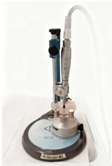
Figura 3 - Padronização do polimento dos corpos de prova. Elaborada pelo autor.
