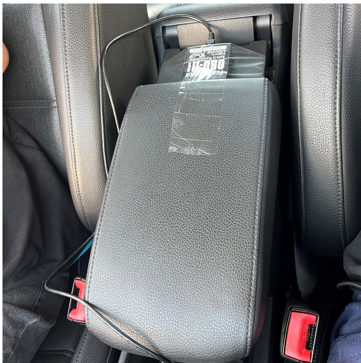
Figura 15 – Instalação da MU integrada à OBD-II próximo ao CG
