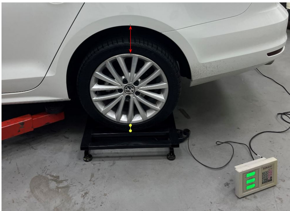
Figura 11 – Teste para determinação da rigidez dos pneus e suspensões
