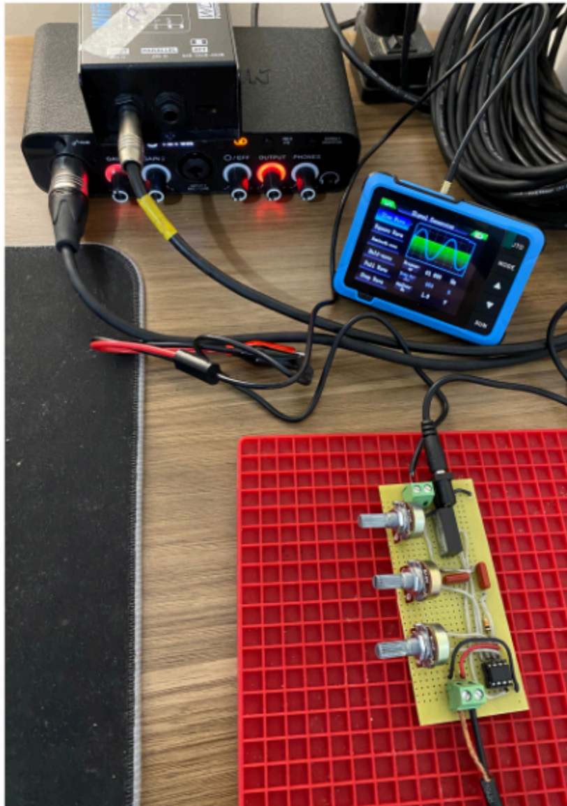
Figura 17 - Testes com filtro analógico e gerador de sinais
