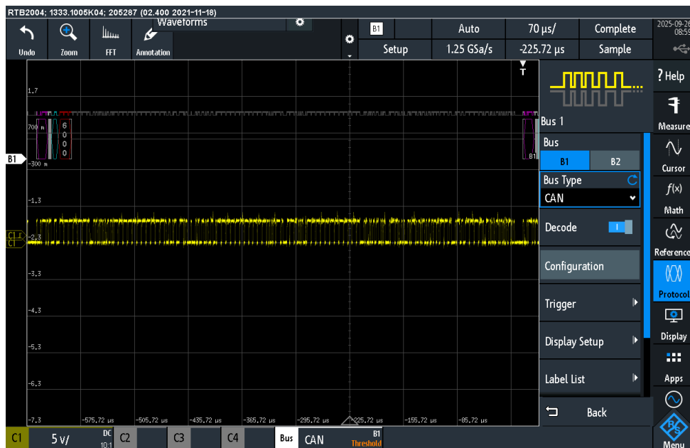
Figura 21 – Captura do osciloscópio no teste do CAN FD
