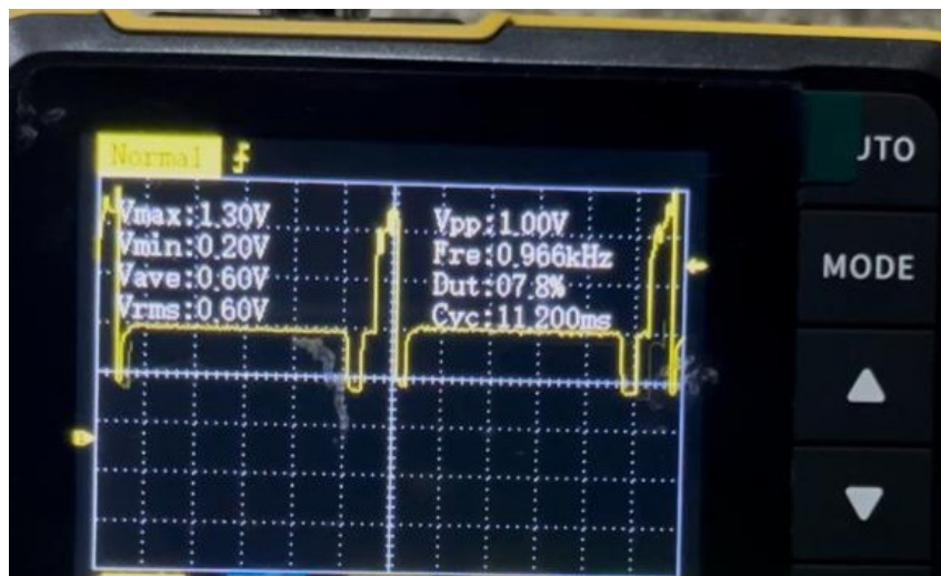
Figura 13 – Sinal de rotação do motor observado no osciloscópio
