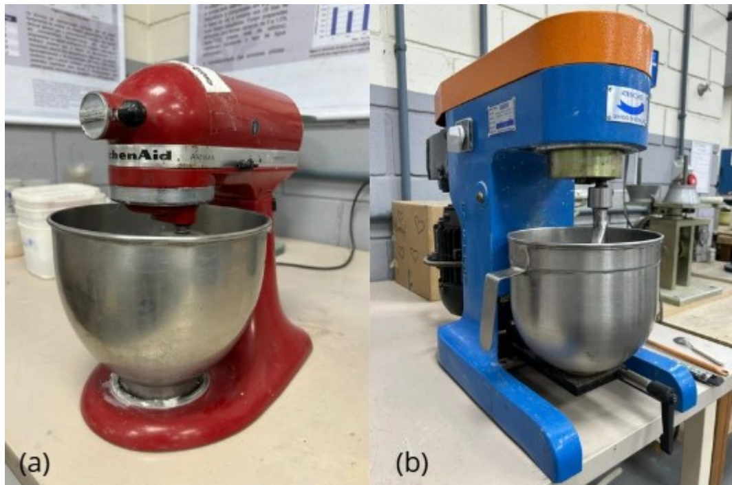
Figura 11 – Misturadora utilizada para a produção da pasta a) geopolimérica; b) cimentícia
