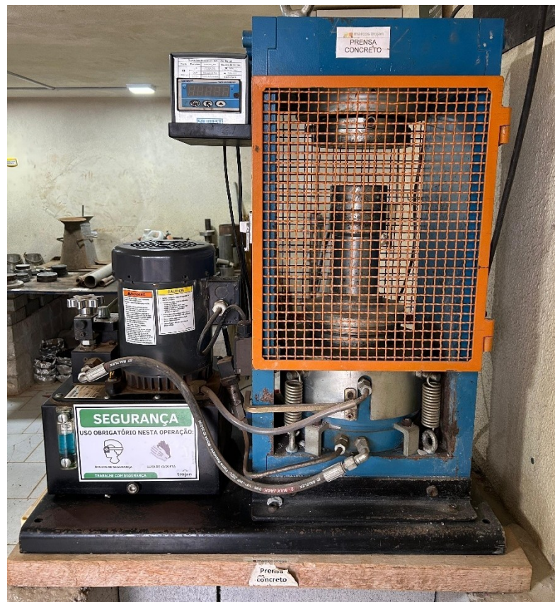
Figura 18 – Prensa utilizada para o ensaio de resistência à compressão das amostras REF, 60 e 70
