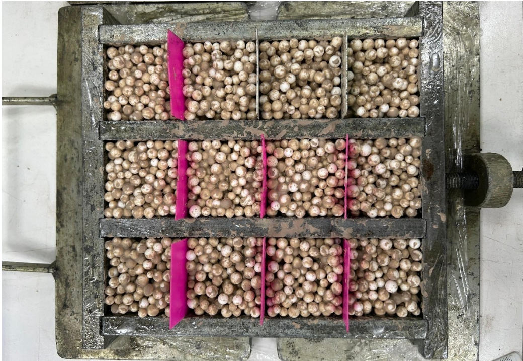
Figura 14 – Corpos de prova da pasta geopolimérica moldados
