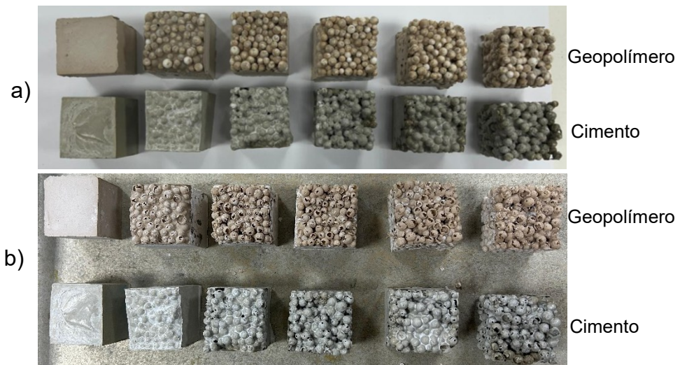
Figura 20 – Amostras do ensaio na temperatura de 200°C a) antes do ensaio e b) após o ensaio
