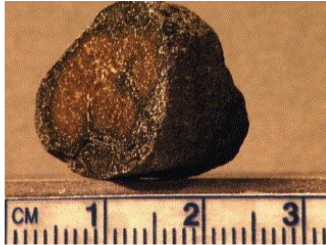
Figura 2 – Grão de clínquer de cimento Portland com face cortada e polida
