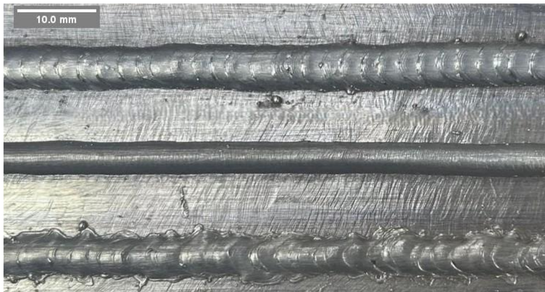
Figura 17 – Vista ampliada dos três modos de transferência metálica
