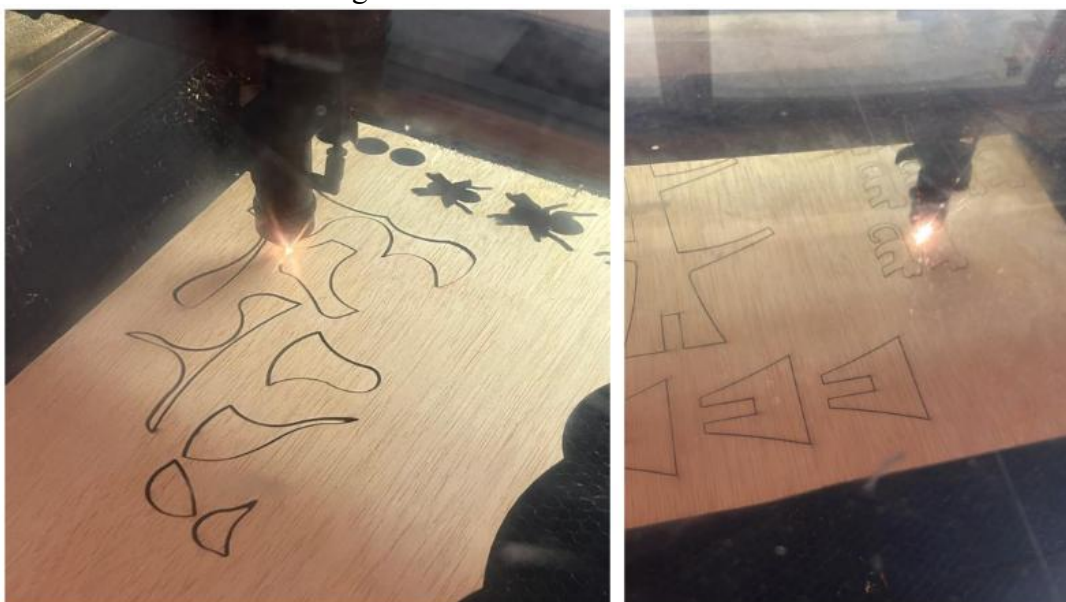
Figura 31 - Corte a laser em CNC
