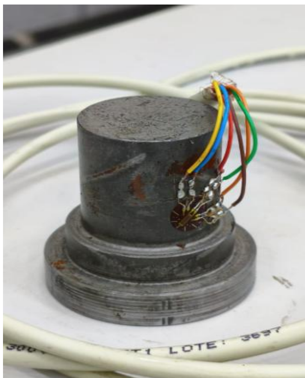
Figura 11 – Extensômetros posicionado no inserto.
