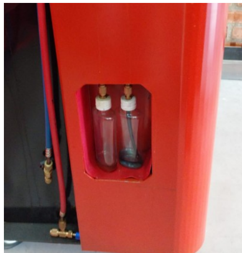
Figura 30 - Reservatório de óleo
