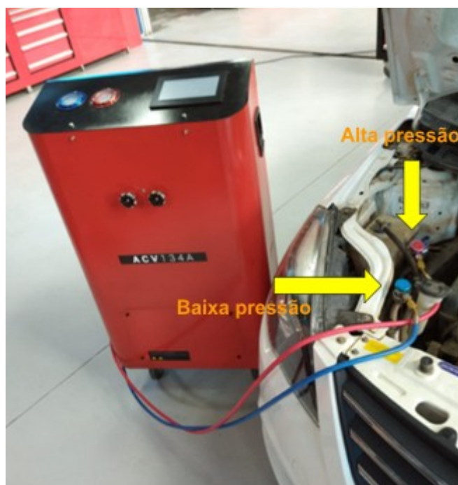
Figura 9 - Mangueiras de serviço
