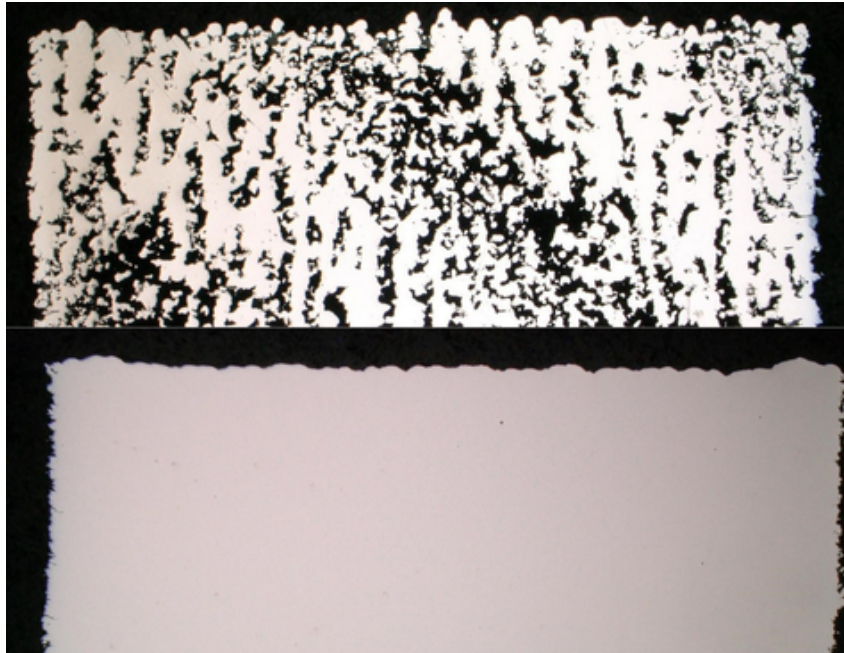
Figura 26 – Seções transversais das amostras com a menor (68,410%) e maior densidade (99,993%), apresentadas, respectivamente, na parte superior e na parte inferior.
