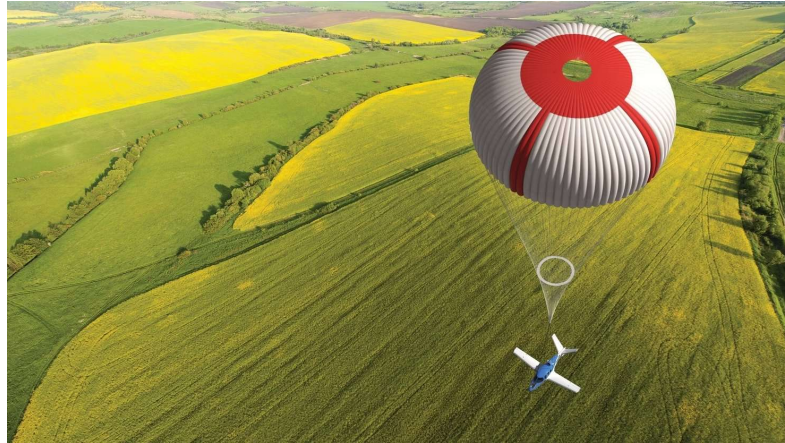
Figura 17 – Cirrus SF50 realizando descida de emergência com paraquedas.
