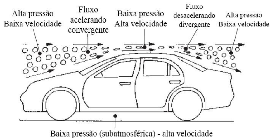
Figura 6 - Velocidade relativa do ar e condições de pressão sobre um veículo em movimento
